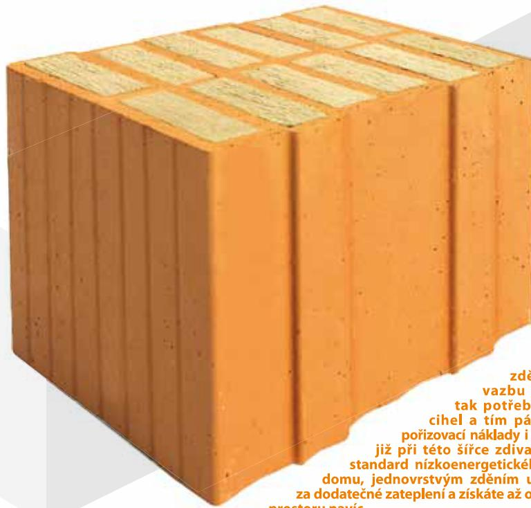
**TIP:** Cihly šířky 36,5 cm umožňují při zdění přirozenou vazbu rohu. Odpadá tak potřeba doplňkových cihel a tím pádem se snižují pořizovací náklady i pracnost. Jelikož již při této šířce zdí splňuje stavby standard nízkoenergetického až pasivního domu, jednovrstvým zděním ušetříte náklady za dodatečné zateplení a získáte až o 13 cm vnitřního prostoru navíc.
